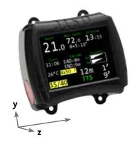
Der OSTC 2 verfügt über einen neigungskompensierten, digitalen 3D-Kompass bis circa 80° Neigung. Wie alle elektronischen Kompasse muss dieser kalibriert werden. So werden feste Abweichungen, wie sie vor allem durch den Akku verursacht werden, ausgeglichen. Auch bei eventuell auftretenden Abweichungen muss der Kompass kalibriert werden.
