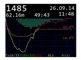
Bei jedem Tauchgang zeichnet der OSTC 2 eine Reihe von Daten zum Tauchgang auf, die Sie im Logbuch abrufen können. Der Logbuch-Speicher bietet Platz für ungefähr 255 Tauchgänge mit einer Gesamtlänge von 500 bis 1000 Stunden. Die genaue Anzahl hängt von der gesamten Datengröße ab. Ist der Speicher vollständig belegt, werden die vorhandenen Tauchgänge überschrieben, beginnend mit dem ältesten.
