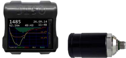
Wenn der Tauchcomputer und der Sender parallel zueinander ausgerichtet sind, kann das Funksignal am besten empfangen werden.
