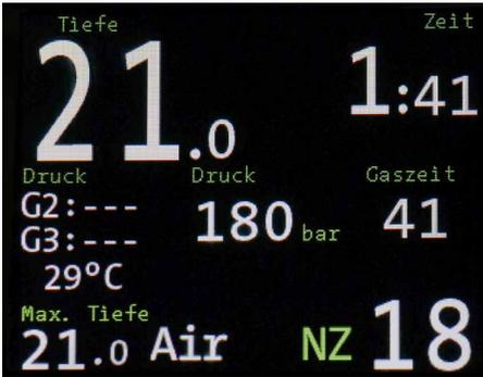
Der Flaschendruck des aktuellen Gases wird immer in der Mitte der Custom View angezeigt.
