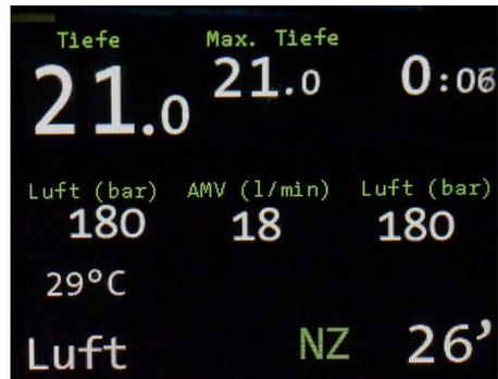
Tauchmodus-Ansicht mit zwei Gasen. Dieser Modus kann zum Sidemount-Tauchen verwendet werden.
